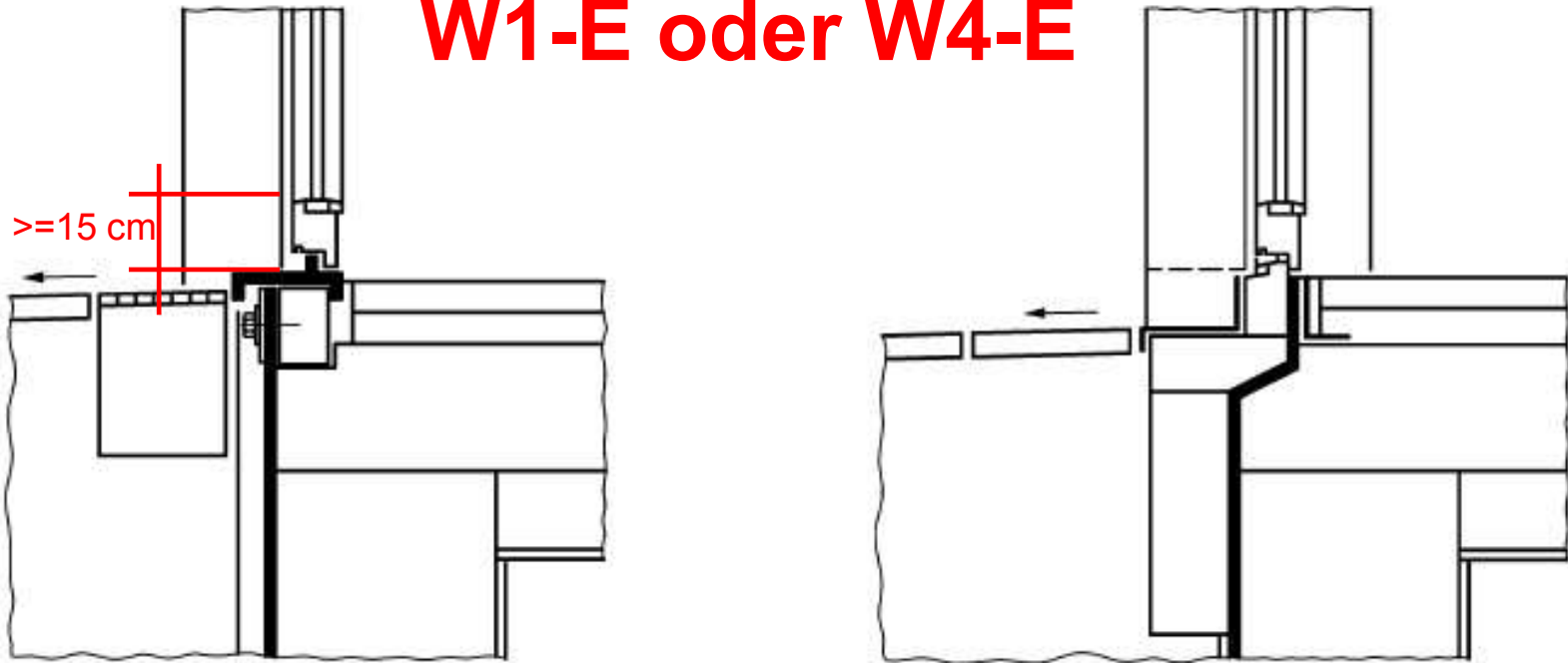
Bild 28 — Beispiele für die Anordnung der Abdichtung bei Türschwellen
